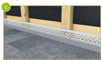
Verschrauben Sie das untere Lüftungsprofil 40 x 30 mm entlang des unteren Abschlusses der Fassade mit der Traglattung bis jeweils 40 mm Abstand zu den Außenecken.
