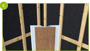
Verwenden Sie das variable Eckprofil (faltbar) zum Verschrauben in den Innenecken, sowie für Außenecken mit einem Winkel größer als 90 Grad.
