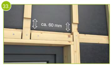
Klinken Sie die Traglattung oberhalb von Fenster- und Türelementen auf einer Länge von ca. 6 cm in einem Bereich aus, wo keine Verschraubung erfolgen muss. Somit wird eine ständige Luftzirkulation im Bereich oberhalb der Elemente sichergestellt (siehe Bild 42).
