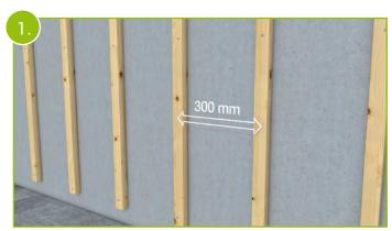
Schrauben Sie die vertikalen Traglatten im Abstand von 30 cm an. Wir empfehlen Dachlatten mit Maßen 40 x 30 mm. Der Abstand Unterkante Traglatte zum Boden sollte mindestens 7 cm betragen. Besonderheiten bei Fenstereinfassungen siehe Abbildungen 33 und 42.
