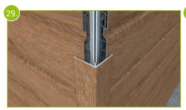
Oberteile des Eckprofils passend auf benötigte Länge zusägen und auf montierte Unterteile aufklipsen. Mögliche Längenausdehnung von 3 mm/Meter beachten!
