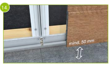
Die Montage der Fassadenprofile beginnt am unteren Fassadenrand, indem das erste Fassadenprofil gemäß Skizze in das Aluminium-Startprofil eingehängt wird. Bitte beachten Sie den Mindestabstand Unterkante Fassadenprofil von 50 mm zum Bodenniveau.
