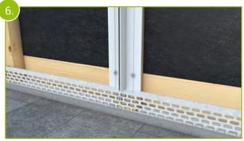
Verfahren Sie ebenso mit den Unterteilen der Verbindungsprofile, wenn ein längsseitiger Stoß der Fassadenprofile erforderlich ist. Die Positionierung der Verbindungsprofile erfolgt mittig auf den Traglatten. Der Abstand zum oberen Fassadenende muss 60 mm betragen.
