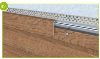
Das Oberteil des 2-teiligen oberen Lüftungsprofils wird exakt dem des Abschlussprofils montiert.
