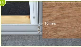
Der Dehnabstand zwischen den Enden der Fassadenprofile und den Enden der 2-teiligen Verbindungs-, Abschluss- und Eckprofile sowie des variablen Eckprofils muss jeweils 10 mm pro Seite betragen (siehe Skizze)!
