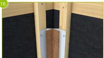
Das variable Eckprofil wird mittels Schrauben entlang der eingebrachten Schraubnuten im Abstand von 40 cm mit den Traglatten fixiert.
